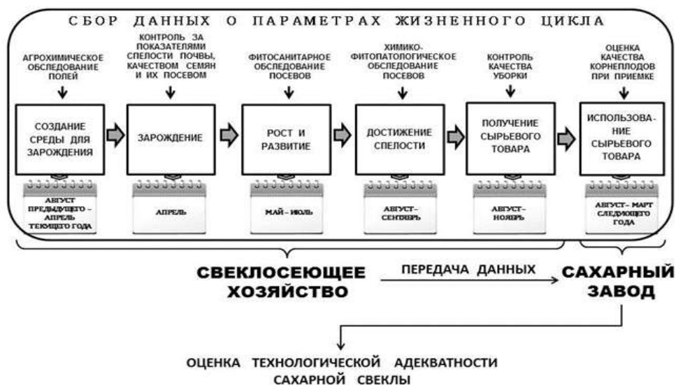
Рисунок 2.2 – Схема реализации процедуры прослеживаемости сахарной свеклы как сырья для производства сахара
