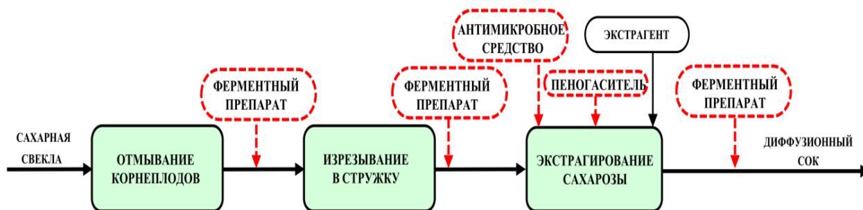
Рисунок 15 – Структурная схема технологических приемов адресности и последовательности введения ТВС
