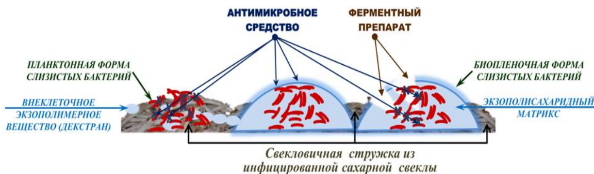
Рисунок 4 – Образование биопленки на свекловичной стружке и воздействие на нее антимикробного средства и ферментного препарата
