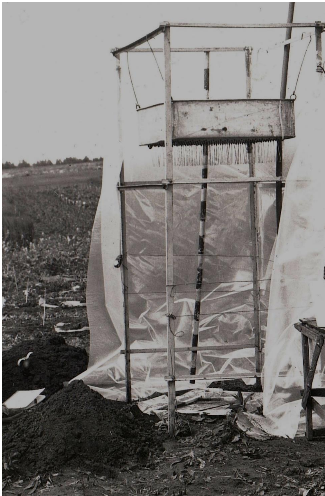
Рисунок 2 – Дождевальная установка с каплеобразователями – медицинскими иглами (фото из архива лаборатории моделирования эрозионных процессов)
