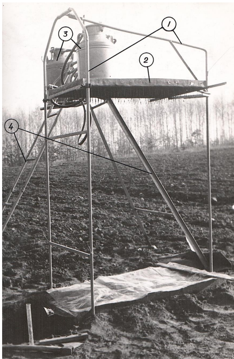
Рисунок 1 – Дождевальная установка с каплеобразователями – гвоздями (фото из диссертации Е. А. Гаршенева)
