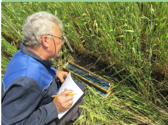
Наблюдение за температурой почвы на разной глубине
